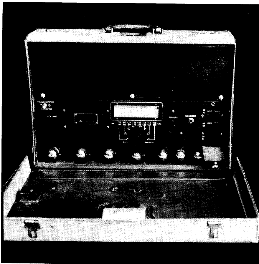
Foto 1. Draagbare peilontvanger BC-792-A in geopende stand. Onderaan de buizen, rechts de accuutjes voor gloei- en anodespanning die er voor laden kunnen worden uitgetrokken. Achter de rubberklep boven de radio bevindt zich de raamantenne. (foto: PAoSE).
